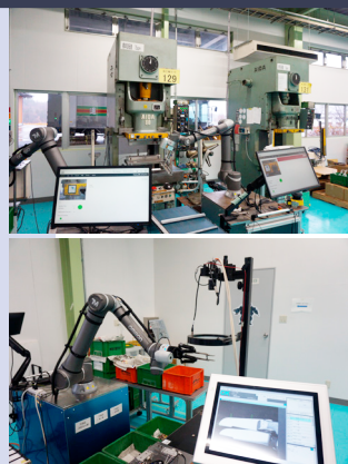
(下) カメラ(画像判定) による検査工程自動化
